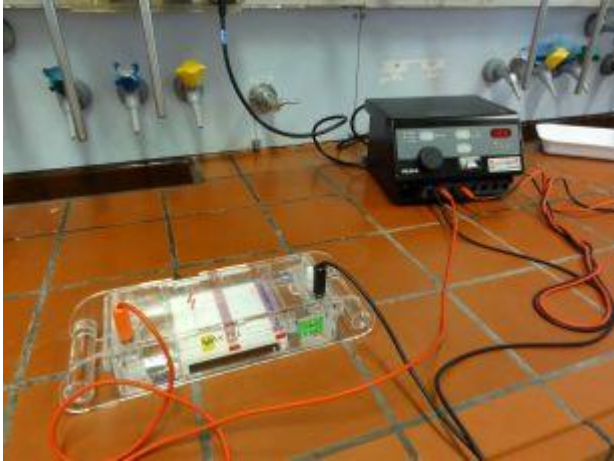
Selbst aufgebaute Gelelektrophoreseapparatur
