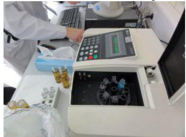
Ein Blick ins Spektralfotometer, mit dem gerade Absorptionsspektren von eigens isolierter Bakterien-DNA gemessen wurden.
